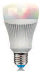
↓ 118 mm, ↔ 66 mm RGBW-LED E27, 11,5 W max. 806 lm, 2.200 - 6.500 K 25.000 h
